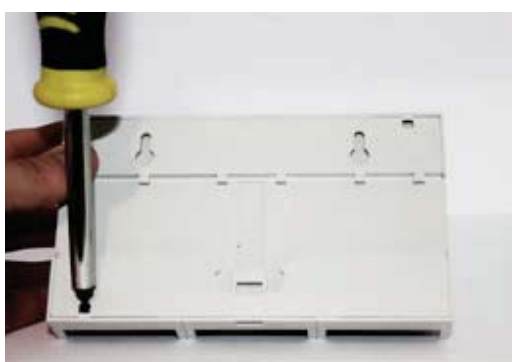
Rimuovere la base Remove the base
